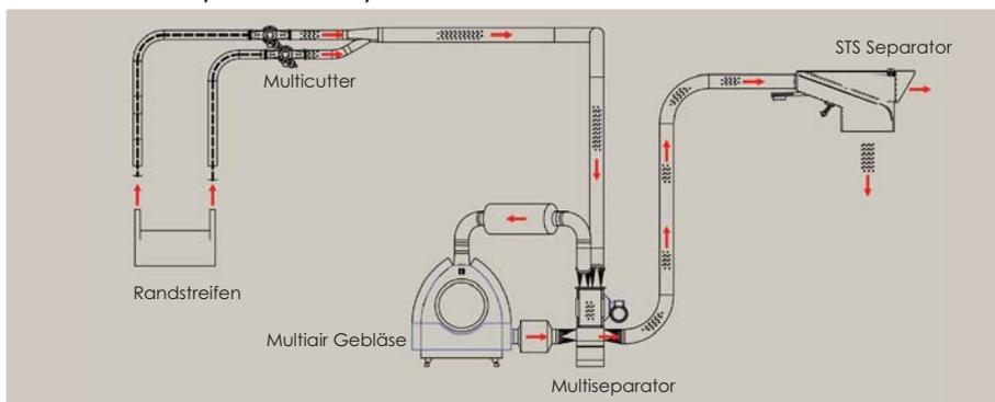
Der Einsatz von Kongskildes Multiseparator RVS 75 ermöglicht die Absaugung kleinerer Abfallstoffe aus Produktionsanlagen, mit denen Papier, Kunststoffolie, Aluminiumfolie, oder Verpackungsmaterial hergestellt wird. Der RVS 75 trennt das leichte Material vom Luftstrom der Absaugleitung und führt es der Druckleitung wieder zu. Der RVS 75 Multiseparator ist besonders für Anlagen geeignet, bei denen es auf eine starke Saugwirkung ankommt.
