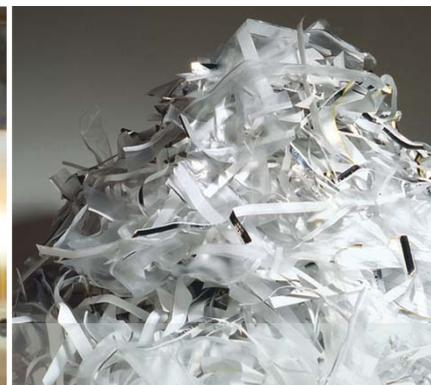
Die Einbindung von Kongskildes Präzisions-Multicutter oder des MC3000 für dickere Materialien kann einem Randstreifenabsaugsystem zusätzlichen Nutzen bringen. Die zwei Hauptvorteile sind eine drastische Reduzierung des Abfallvolumens am Austragepunkt und die Möglichkeit, den geschnittenen Randstreifen über längere Entfernungen fördern zu können.
