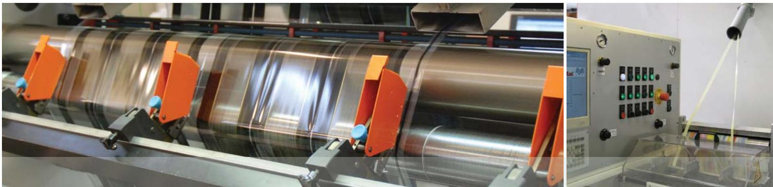
Kongskilde-Systeme für Produktionsabfall können Randstreifen aus Folien produzierenden Maschinen (Chillroll-Anlagen) und Verarbeitungsmaschinen (Rollenschneidmaschinen/ Wickler) absaugen.
