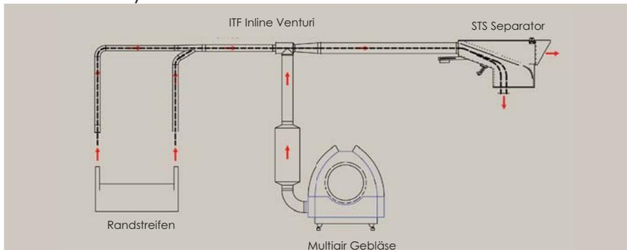
Das Gebläse erzeugt einen Luftstrom. Durchströmt dieser das ITF Venturi, erzeugt er an der Quelle einen Unterdruck, der den Randstreifen in das System saugt. Nachdem Randstreifen und Luftstrom das Venturi passiert haben, wandelt sich das System dahinter in ein Drucksystem, welches den Randstreifen zum Austragepunkt fördert.
