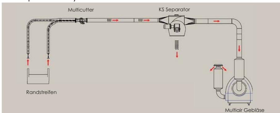
Dieses System nutzt die Saugseite des Gebläses. Es erzeugt einen Unterdruck, der die geschnittenen Randstreifen in den KS Separator saugt. Der KS Separator ist ein sich langsam drehendes Ventil, in dem Luft und Material getrennt werden. Mittels Gravitation wird das Material vertikal abgeschieden. Luft und Staubpartikel gelangen zum Gebläse. Schließlich durchströmt die Luft einen Filter, bevor sie freigesetzt wird.
